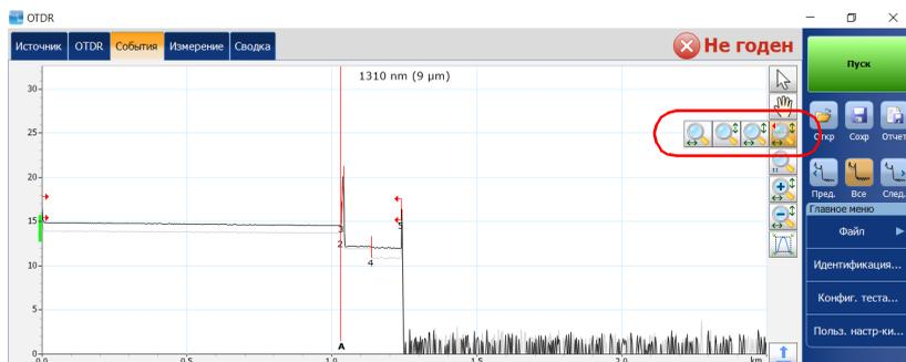
Затем, определив область масштабирования с помощью стилуса или пальца (для облегчения определения области отобразится прямоугольник с пунктирными линиями). Если стилус отпустить, график автоматически увеличивается приложением в соответствии с выбранным типом масштабирования. Все другие кнопки масштабирования (за исключением масштабирования на выбранной кнопке события) будут отражать выбранный элемент и функционировать соответствующим образом.
