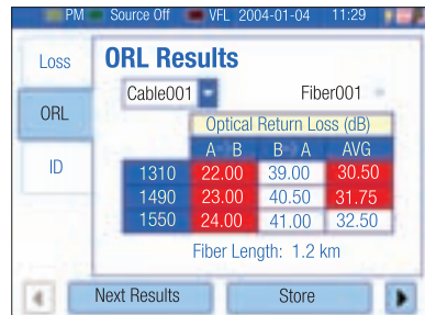
Рисунок 4-9. Плохие значения ORL (согласно спецификации 32 дБ)
