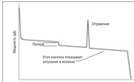
Рисунок 4–12. Участок кабеля, измеренный от входа разветвителя к выходу WDM мультиплексора
