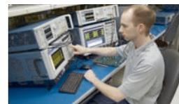
Сигналы, захваченные осциллографами или анализаторами спектра, могут воспроизводиться на дисплее генератора.
