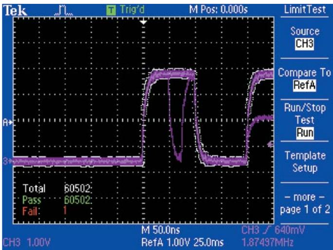
Функция контроля предельных значений выполняет быструю разработку типа «годен/не годен», сравнивая входные сигналы с определенными пользователем шаблонами.
