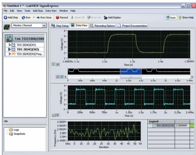
Простой захват, сохранение и анализ результатов с помощью прилагаемой базовой версии ПО LabVIEW SignalExpress от компании National Instrument.
