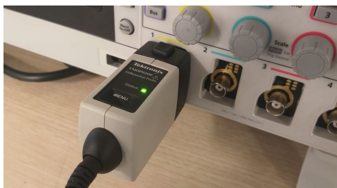
Пробники с интерфейсом TekVPI® передают в осциллограф TBS2000B настройки масштабных коэффициентов, диапазонов и данные о состоянии.
