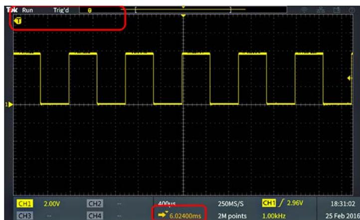
Точка запуска за пределами экрана (значение времени задержки отображается в нижней части экрана).
