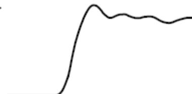
Вид сигнала с длинным проводом заземления
