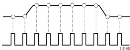
В осциллографах серии TBS2000 используется дискретизация в реальном масштабе времени. При дискретизации в реальном масштабе времени в осциллографе происходит выборка и аналого-цифровое преобразование всех выбранных значений одновременно с последовательной записью полученных значений в память и циклическим повторением процесса выборки и записи.
