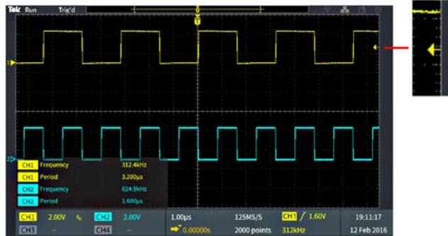
При запуске по импульсам малой амплитуды осциллограф отображает две отметки уровней запуска. В режиме запуска по импульсам малой амплитуды ручка «Уровень» управляет только величиной нижнего порогового уровня. С помощью **Trigger Menu** (Меню запуска) устанавливают оба уровня запуска.
