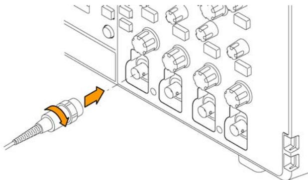
4. Подсоедините наконечник пробника и провод заземления к гнездам **PROBE COMP** (КОМПЕНСАЦИЯ ПРОБНИКА) на передней панели осциллографа. Наконечник пробника вставляют в гнездо 5 В, а зажим заземления подключают к соединителю заземления.
