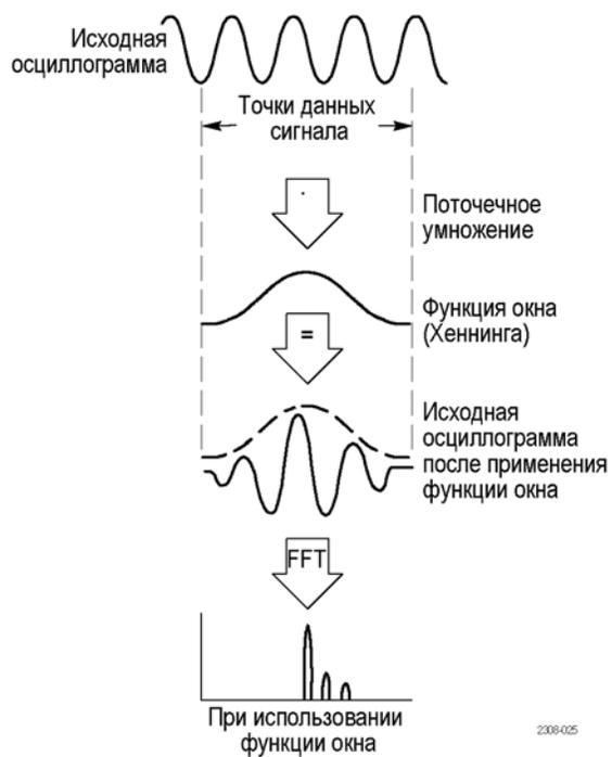
Различные конфигурации окна обеспечивают компромисс между точностью по частоте и точностью по величине составляющих. Выбор вида окна определяется необходимостью измерения конкретных параметров и свойствами исходного сигнала. Приведенные ниже указания помогут наилучшим образом выбрать окно для выполнения требуемого анализа. Окно Хеннинга — хорошо подходит для первоначальных измерений БПФ.
