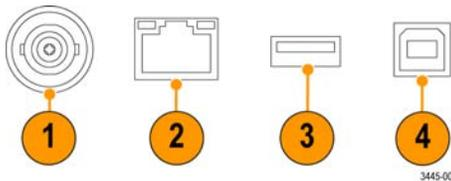
**ПРИМЕЧАНИЕ.** Вспомогательный выход *Aux Out* выдает сигнал запуска из последнего активного канала до тех пор, пока служащий источником синхронизации сигнал поступает, даже если этот канал отключен.
