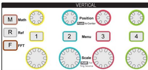
С помощью органов управления группы «ПО ВЕРТИК.» устанавливают настройки по вертикали (положение и масштаб) для каждого канала и позволяют включить и отключить настройку параметров для каждого сигнала.
