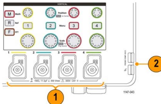
2. Соединитель **PROBE COMP**. Для настройки компенсации искажений пробников используют источник прямоугольных импульсов и соединение с землей.
