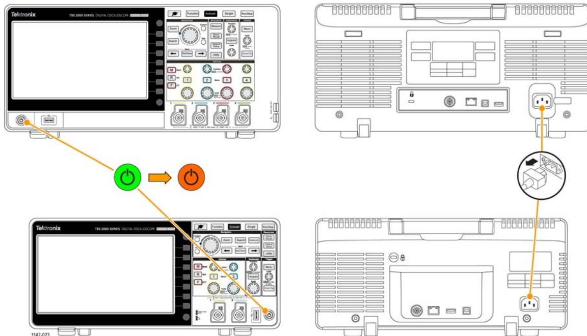
**ПРИМЕЧАНИЕ.** При выключении осциллографа текущие настройки прибора сохраняются в энергонезависимой памяти. При включении осциллографа происходит восстановление настроек.
