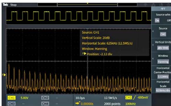
3. Нажмите кнопку **Исх. сигнал** бокового меню для включения или выключения отображения графика исходного сигнала (в верхней части экрана) выбором **Вкл** или **Откл.**
