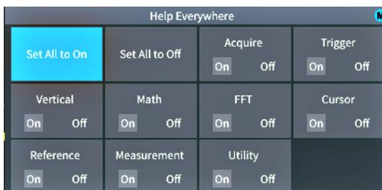
4. Для включения и выключения разрешения вывода содержимого системы **Справка везде** для отдельных категорий функций воспользуйтесь **многофункциональной** ручкой и выберите требуемую категорию, после чего нажмите ручку для изменения настройки **Вкл** или **Выкл.**
