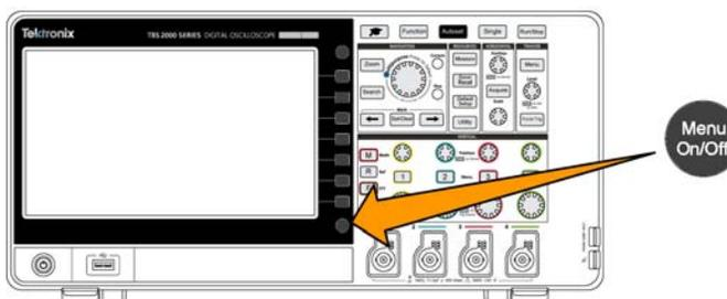
6. Если выбран язык, отличный от английского, следует установить пластиковую накладку на переднюю панель с надписями на этом языке. Загните выступы вкладки. Вдвиньте накладку до основания кнопок передней панели, пропустив кнопки в отверстия. Вставьте выступы накладки в небольшие щели корпуса до щелчка.
