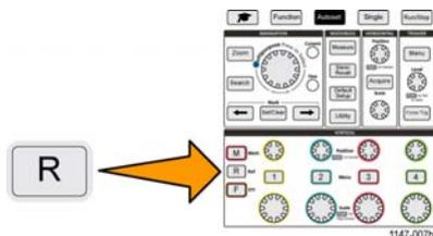
2. Нажмите кнопку **Опорн. 1** или **Опорн. 2** бокового меню для отображения **Вкл** или прекращения отображения **Выкл** сигнала.
