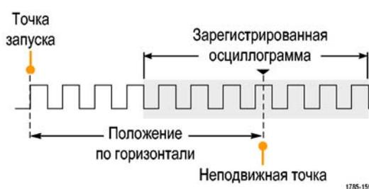
3. При задании состояния функции **Задержка Вкл**, точка запуска отвязывается от неподвижной точки расширения. Вращением ручки **Положение** группы «ПО ГОРИЗ.» можно двигать точку запуска от неподвижной точки расширения (центра координатной сетки). Величина задержки отображается в области состояния по горизонтали в нижней центральной части координатной сетки относительно точки 0 с (центра координатной сетки).
