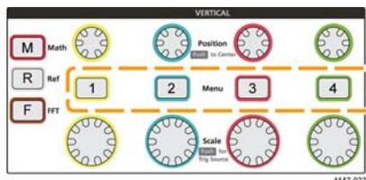
Если выбранный канал уже активен, нажатие кнопки **Меню** канала приводит к удалению Осциллограммы. Если выбранный канал неактивен, нажатие кнопки **Меню** канала означает выбор канала; при следующем нажатии осциллограмма сигнала удаляется с экрана.
