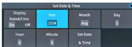
4. Нажмите **многофункциональную** ручку, чтобы выбрать нужный год. Числовое поле обозначено белым прямоугольником, который указывает возможность использования **многофункциональной** ручки для изменения значения.
