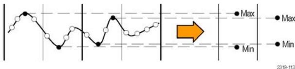
В режиме «Выс. разр.» происходит повторная дискретизация низкочастотных сигналов и вычисление среднего значения всех отсчетов для каждого интервала регистрации. Использование режима «Выс. разр.» обеспечивает получение отсчетов с повышенным разрешением (16 бит) для низкочастотных сигналов.
