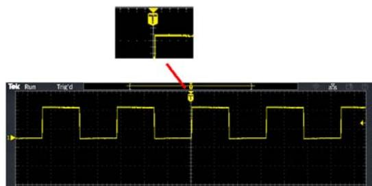
4. На осциллограмме записи сигнала отображается расположение точки запуска в записи сигнала. Цвет линии соответствует цвету выбранной осциллограммы. Область в скобках показывает часть записи, которая в данный момент отображается на экране.
