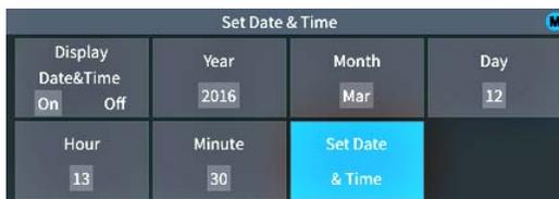
8. Для прекращения и возобновления отображения даты и времени выберите **Показать дату и Время** и нажмите **многофункциональную** ручку для включения **Вкл** или выключения **Выкл** отображения.
