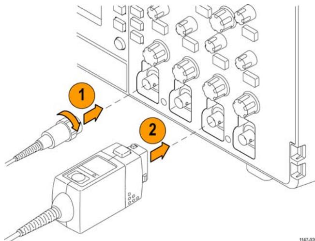
2. Универсальный интерфейс пробника Tektronix (TekVPI®): Вставьте основание пробника в соединитель канала до характерного щелчка соединителя основания в приборе. Для расчленения соединения основание пробника следует вытянуть из соединителя прибора при нажатой кнопке на основании пробника.
