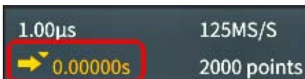
С помощью регулировки положения по горизонтали можно ввести задержку между моментом синхронизации и фактическим началом регистрации данных. Для получения информации о сигнале до наступления момента запуска задают отрицательные значения времени задержки.
