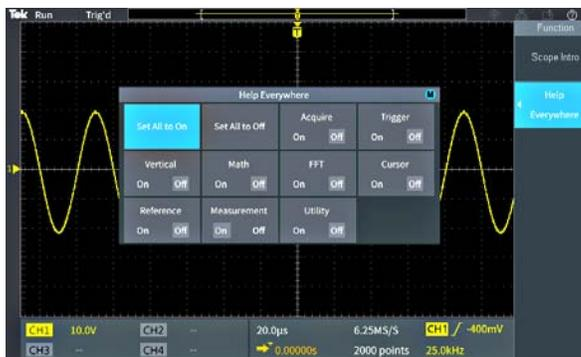
3. Для включения и выключения разрешения вывода содержимого системы **Справка везде** воспользуйтесь **многофункциональной** ручкой и выберите **Вкл. все** или **Выкл. все**, после чего нажмите ручку.
