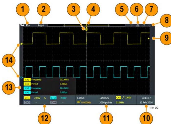
1. Статус сбора данных отображает текущий режим сбора данных: сбор данных выполняется, остановлен или включен предварительный просмотр. Имеются следующие режимы сбора данных:
