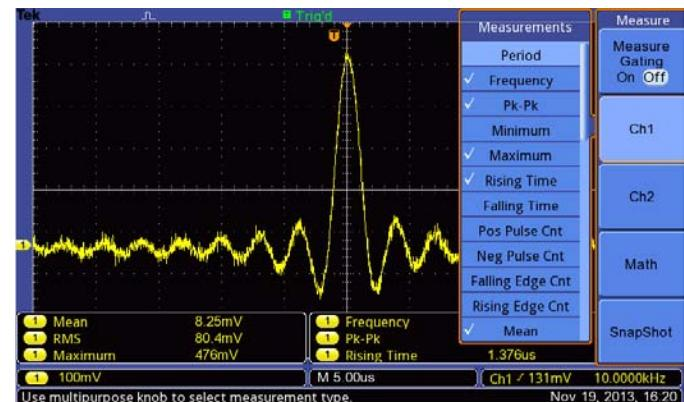
Быстрый анализ сигналов с помощью 34 стандартных видов автоматических измерений
