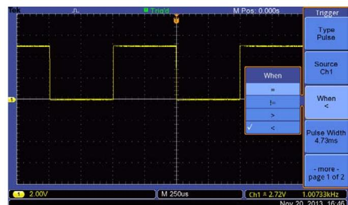
Применяя функцию запуска по длительности импульса, можно легко захватывать важные события.
