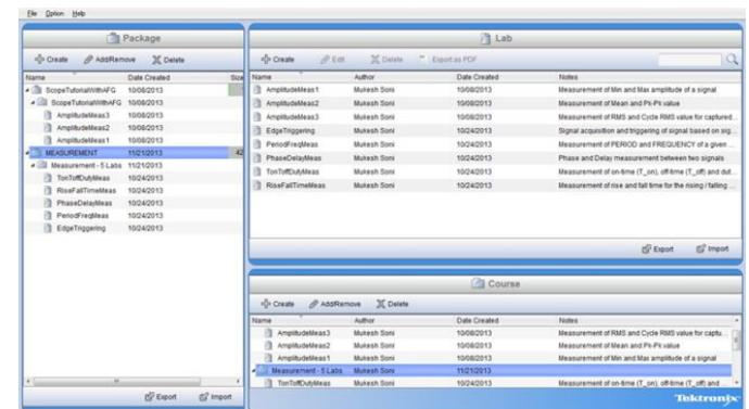
Интерфейс обучающего ПО позволяет составлять курсы на основе лабораторных работ. Из готовых курсов формируются файлы, которые можно загружать в осциллограф.
