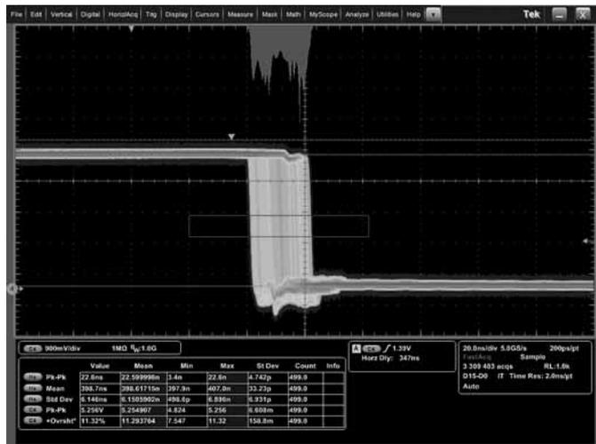
*Анализ. Гистограмма спада сигнала, отображающая распределение положения спада (джиттер) во времени. Приведены численные результаты измерений, выполненных на гистограмме сигнала. Обширный набор встроенных средств анализа позволяет ускорить проверку тестируемого устройства*
