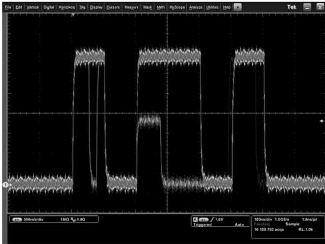
На приборах серии MSO/DPO5000 технология DPX позволяет осуществлять захват сигналов со скоростью свыше 250 000 осциллограмм/с. Цветовая градация частоты появления событий на экране позволяет идентифицировать редкие события и сбои в реальном времени.
