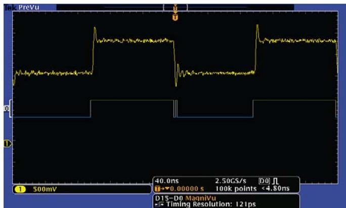
Режим быстрого захвата MagniVu обеспечивает разрешение по времени 121,2 пс, позволяя выполнять точные измерения временных характеристик цифровых сигналов.
