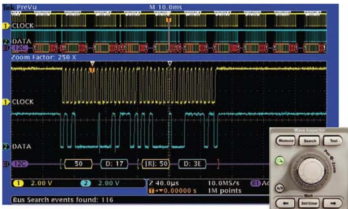
**Поиск:** функция декодирования шины I<sup>2</sup>C, показывающая результаты поиска адреса 50. Панель управления Wave Inspector обеспечивает непревзойденную эффективность просмотра и навигации.
