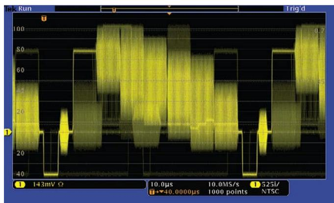
Исследование видеосигнала NTSC. Обратите внимание, что создаваемое осциллографом DPO изображение с градациями яркости позволяет отобразить длительность сигнала, амплитуду и распределение амплитуды во времени.
