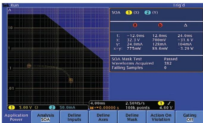
Определение области устойчивой работы. Функции автоматического измерения характеристик питания позволяют быстро и точно анализировать традиционные параметры источников питания.
