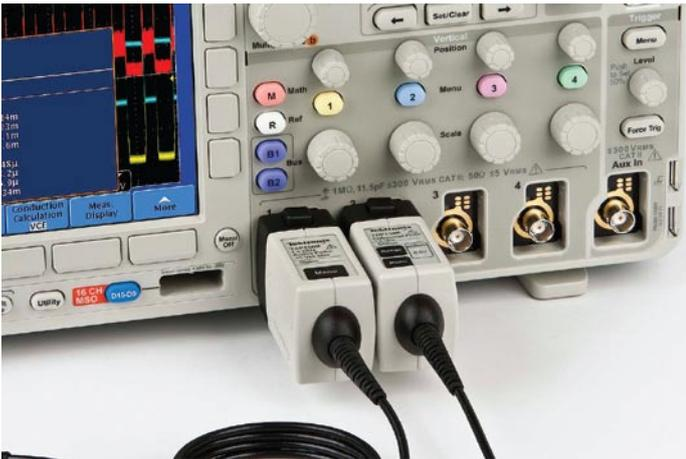
Интерфейс TekVPI упрощает подключение пробников к осциллографу.
