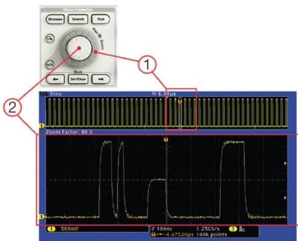
Панель управления Wave Inspector обеспечивает непревзойденную эффективность просмотра, навигации и анализа данных. Поворотом внешней ручки панорамирования можно пролистать все 5 млн. точек записи (1). Перемещение из начала в конец займет считанные секунды. А если вы увидели нечто интересное и хотите подробнее это рассмотреть? Просто поверните внутреннюю ручку масштабирования (2).
