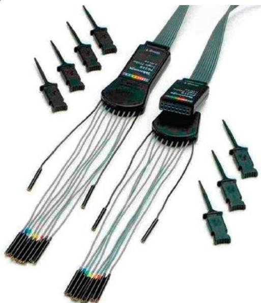
Пробник P6316 MSO имеет две группы по восемь контактов, упрощая подключение к тестируемому устройству.
