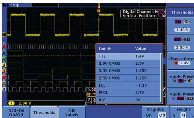
Цветовое кодирование цифровых сигналов позволяет объединять их в группы, просто располагая их на экране рядом друг с другом. Затем помеченные цифровые каналы можно перемещать единой группой. Для каждой группы из восьми каналов можно установить отдельные пороги, что обеспечивает поддержку логических устройств двух разных типов.
