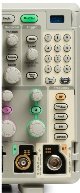
Основные параметры спектра быстро настраиваются с помощью специального меню на передней панели и клавиатуры.
