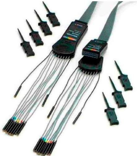
Пробник для цифровых каналов P6316 имеет две группы по восемь контактов каждая, что упрощает подключение к исследуемому устройству.
