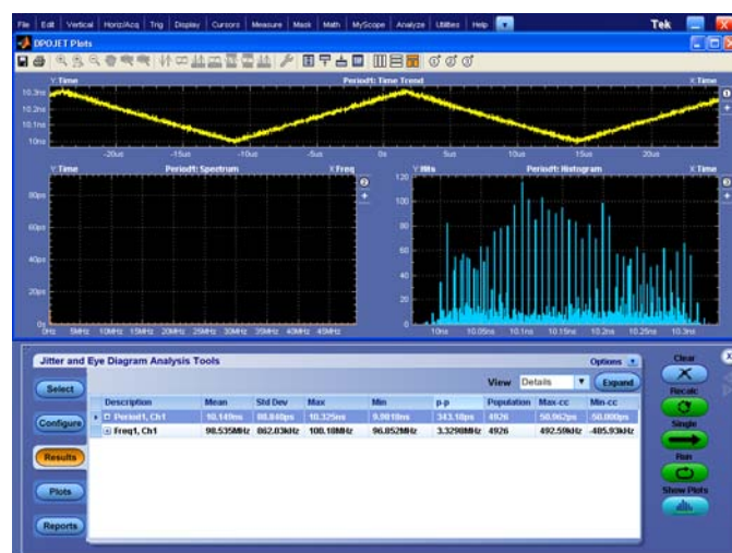
Расширенные измерения джиттера, глазковых диаграмм и временных характеристик.
