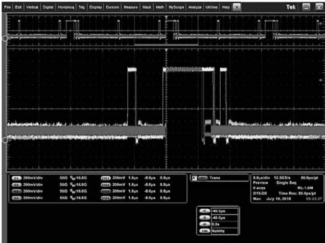
Решение для анализа и измерения параметров устройств MIP®D-PHY (опция D-PHY). ПО для проверки соответствия протоколу D-PHY, позволяющее быстро обнаружить причины появления джиттера, измерить его параметры и нарушения целостности сигналов. При совместном использовании с опцией DPOJET опция D-PHY позволяет выполнить измерения временных соотношений сигналов передатчика, а также других электрических параметров в высокоскоростных режимах или режимах низкого энергопотребления.
