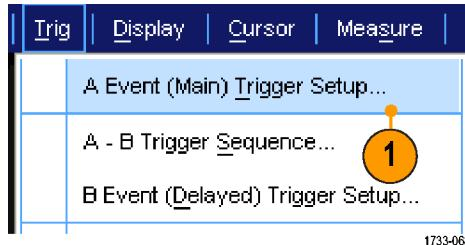
2. Задайте тип и источник синхронизации А на вкладке события A Event.
