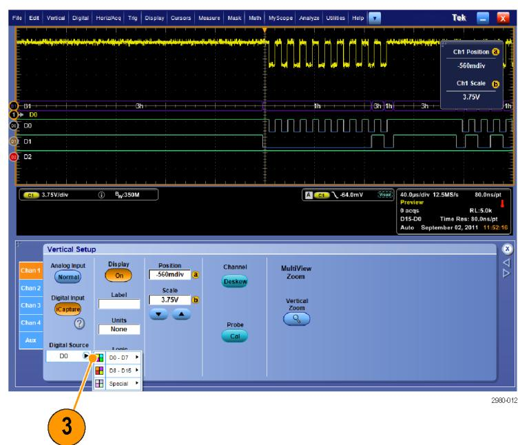
4. Чтобы установить пороговые значения, используемые при преобразовании аналоговой осциллограммы в цифровой формат для подключения к шине, нажмите кнопку **Logic Properties** (свойства логического сигнала).
