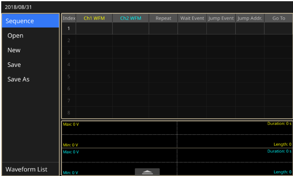
Рисунок 23: Экран последовательности сигналов одноканального генератора
