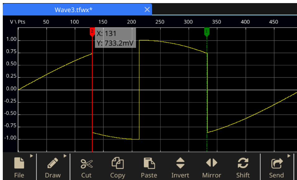
Рисунок 145: Результат зеркального отображения сигнала в ArbBuilder
