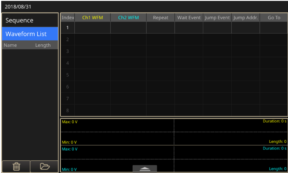
Рисунок 22: Главный экран расширенного режима двухканального генератора
