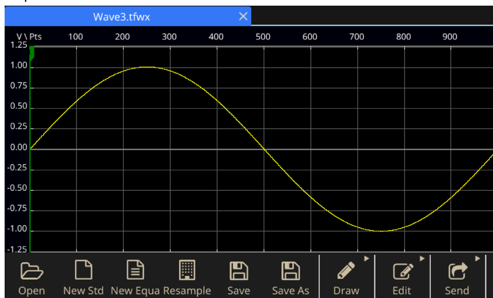
Рисунок 136: Сигнал синусоидальной формы в ArbBuilder
