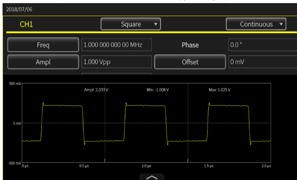
Рисунок 72: Сигнал на входе K1 осциллографа с нагрузкой 1 МОм – InstaView
