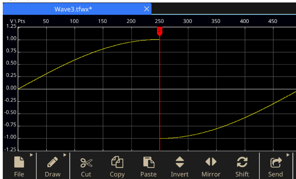
Рисунок 141: Вырезание выделенных данных сигнала в ArbBuilder
