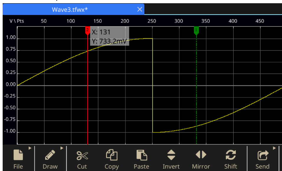
Рисунок 144: Зеркальное отображение сигнала в ArbBuilder
