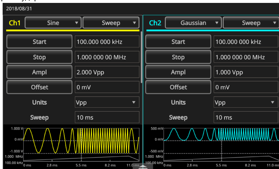
Рисунок 33: Настройки сигнала в режиме sweepирования
