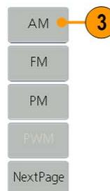
4. Нажмите кнопку **Source** (Источник), чтобы выбрать **Internal** (Внутренний) или **External** (Внешний). Если выбран источник **External** (Внешний), используйте разъем Ext Mod In на задней панели для подачи внешнего сигнала; настройка AM закончена. Если выбран **Internal** (Внутренний), выполните следующие действия.
