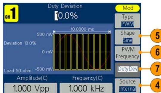
7. Нажмите кнопку **DutyDev** (Отклонение при работе), воспользуйтесь ручкой общего назначения, чтобы настроить отклонение при работе, или используйте цифровую клавиатуру, а затем выберите единицы.
