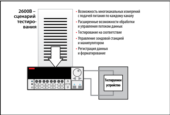
Рис. 11. Пример сценария тестирования для источника-измерителя серии 2600
