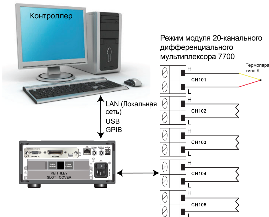
Рис. 44. Подключения устройств к прибору DAQ6510 — мониторинг перед сканированием
