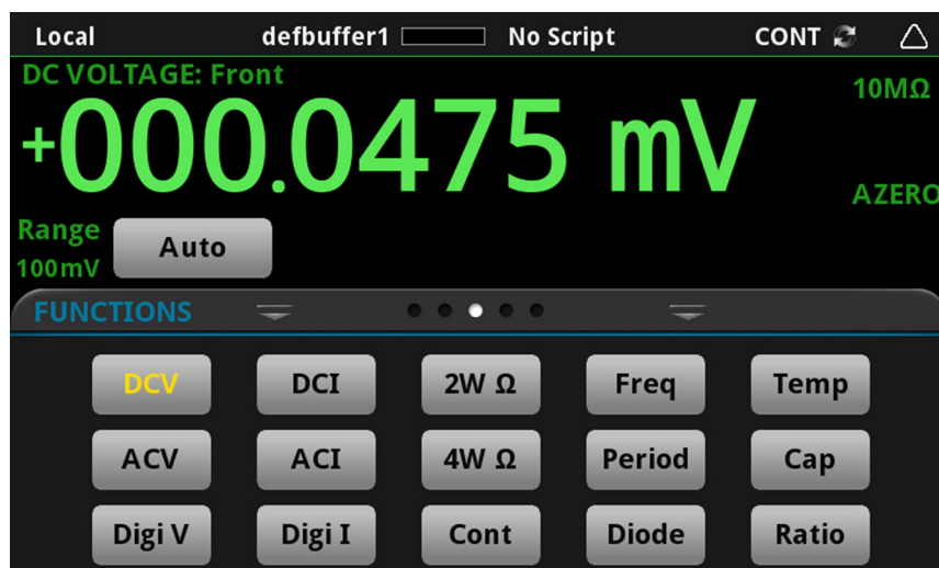
Рис. 6. Прокручиваемый экран FUNCTIONS (Функции)
