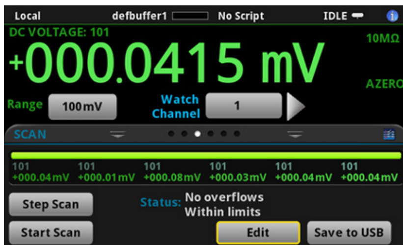
Рис. 13. Прокручиваемый экран SCAN (Сканирование): результаты сканирования
