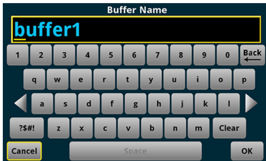
Рис. 3. Клавиатура на передней панели прибора DAQ6510 для ввода информации
