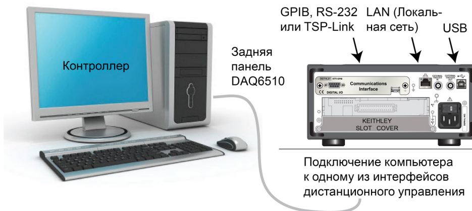
Рис. 16. Подключения интерфейсов дистанционного управления прибором DAQ6510
