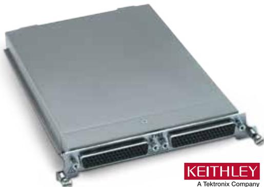
Модуль управления 7705 обеспечивает независимую коммутацию 40 каналов. Эти каналы предназначены для управления подачей питания на тестируемое устройство и коммутации нагрузок. Кроме того, каналы можно использовать для непосредственного управления световыми индикаторами, реле и т.п.
