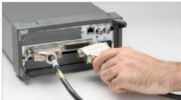
Многие подключаемые модули коммутации имеют многоконтактные разъёмы D-sub, гарантирующие безопасные соединения с минимальным обслуживанием в системе автоматического тестирования. Разъёмы D-sub позволяют минимизировать время простоя при замене модулей коммутации в процессе технического обслуживания или настройки новой системы тестирования.
