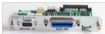
KTTI-GPIB – интерфейс GPIB с 6 цифровыми портами ввода-вывода.
