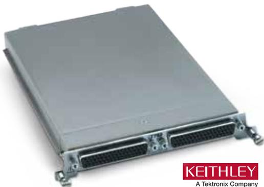
Подключаемый модуль 7703 представляет собой мультиплексор с 32 2-полюсными каналами или 16 4-полюсными каналами, которые можно сконфигурировать как два независимых блока мультиплексоров. Герконовые одностабильные реле, используемые для повышения скорости, рассчитаны на 300 В, 500 мА; 10 ВА. Данные о числе коммутационных циклов хранятся во встроенной памяти. Это идеальное решение для измерения сопротивления при помощи термометра сопротивления или термистора.
