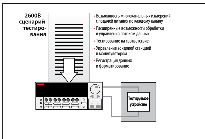
Рис. 11. Пример сценария тестирования для источника-измерителя серии 2600
