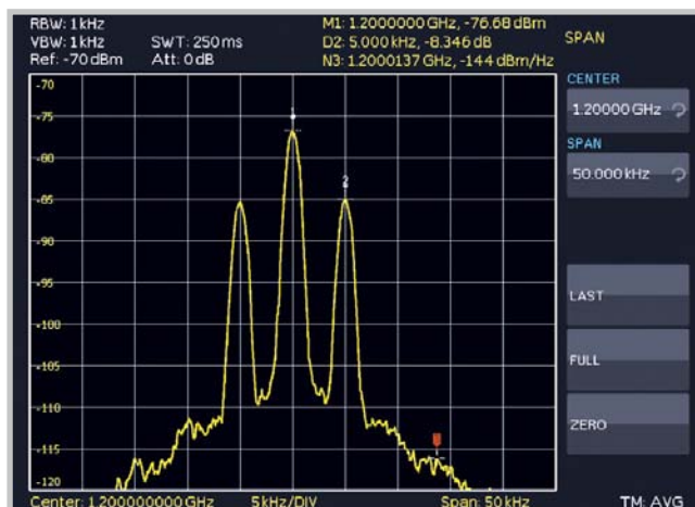
Абсолютный маркер M1; дельта маркер D2; шумовой маркер N3
