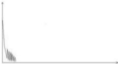
Если тестируемая трасса похожа на изображенную слева, это может быть вызвано несколькими причинами: плохой стыковкой между коннекторами выходного порта и трассы-оптическое излучение не попадает в волокно или сломом волокна в начале трассы, рядом с первым соединением а также большим установленным диапа. расстояний и длит. импульса.
