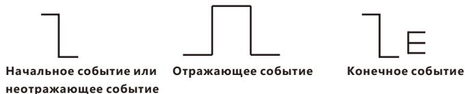
Событиями на трассе называются все точки, где потери мощности изменяются нетипично. Обычно это различные типы стыковок и изгибы волокна, трещины, сломы и т.д. События отмечаются на трассе специальными отметками, означающими отклонение от нормальной трассы.
