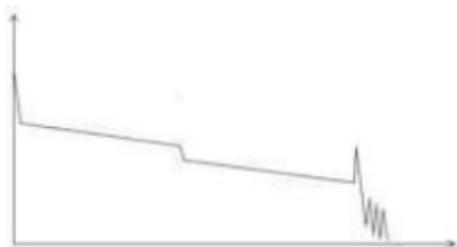
При этом явлении на рефлектограмме тестируемой трассы наблюдается ступенька. Часто это вызвано изгибом волокна, узлом, нагрузкой на данную точку или сваркой волокон. Ступенька означает увеличение потерь в волокне, это точка события. Если наклон отрицательный – это неотраж. событие. Если наклон положительный – это отражающ. событие.
