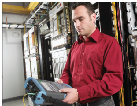
Наиболее компактное портативное решение для тестирования с восемью длинами волн – рефлектометр EXFO FTB-7400E, позволяющий проводить быстрый поиск неисправностей через CWDM мультиплексоры и демультиплексоры.
