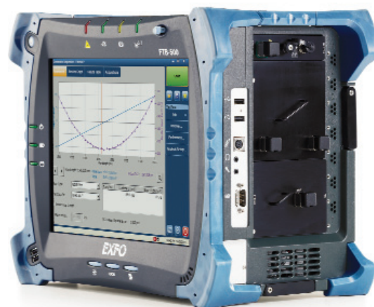
Анализаторы ХД и ПМД установленные в платформу FTB-500 производства компании EXFO
