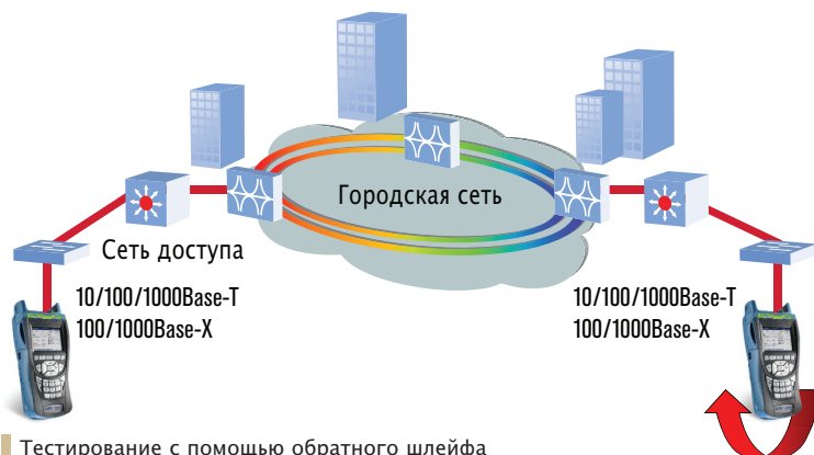
Тестирование с помощью обратного шлейфа
