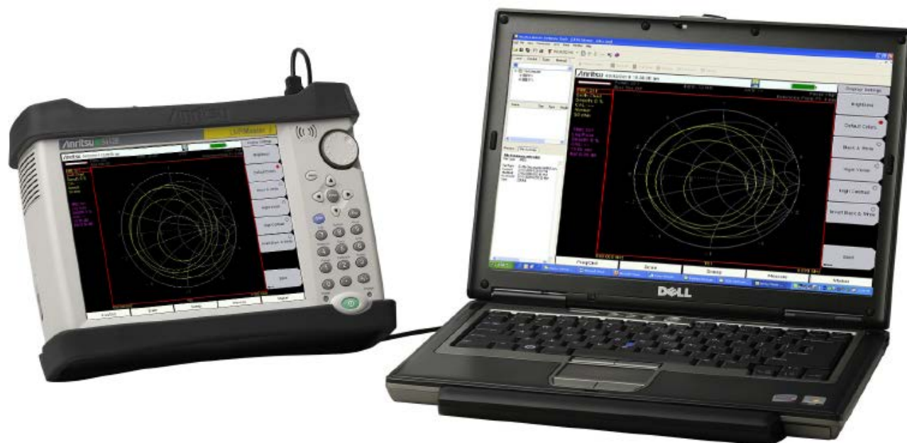
Рисунок 2-9. Подключение LMR Master к ПК по USB Mini-B
