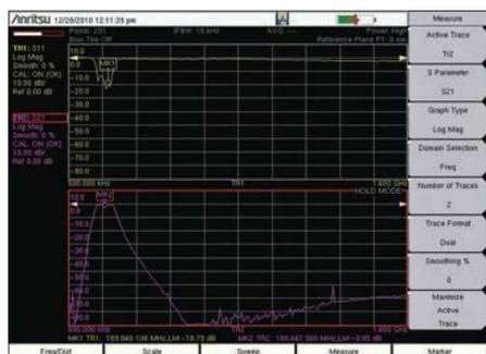
Режимы анализатора АФУ и ВАЦ позволяют одновременно выполнять измерения вносимых потерь и потерь на отражение.
