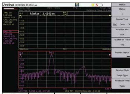
Благодаря функции анализа в области расстояний (DTF), возможен одновременный просмотр величины обратных потерь в кабеле и расстояния до неисправности.
