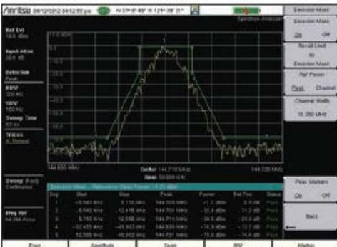
В режиме анализатора спектра LMR Master позволяет проводить автоматизированные измерения, включая измерения ширины занимаемой полосы частот, мощности в соседнем канале и маску излучения, как показано выше. Маска может быть быстро создана с помощью стандартного редактора ограничительных линий. Функция измерения маски излучения автоматически перемещает полученную кривую так, чтобы пик модулированного сигнала соответствовал общим стандартам маски.
