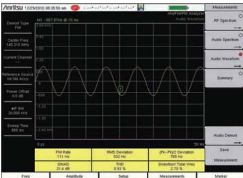
Опция 509 «Измерение параметров модуляции AM/ЧМ/ФМ» отображает спектр демодулированного аудиосигнала относительно времени с AM (%), девиацией (кГц) или девиацией (рад) для AM/ЧМ/ФМ, соответственно.
