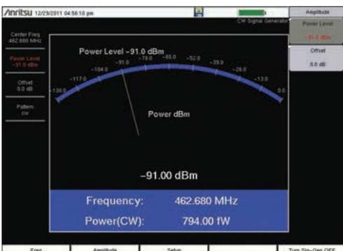
LMR Master стандартно оснащен генератором сигналов с покрытием от 500 кГц до 1,6 ГГц и диапазоном управления мощностью в 120 дБ.
