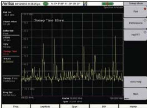
В режиме анализатора спектра LMR Master обеспечивается высокая скорость развертки для поиска источников кратковременных сигналов помех.
