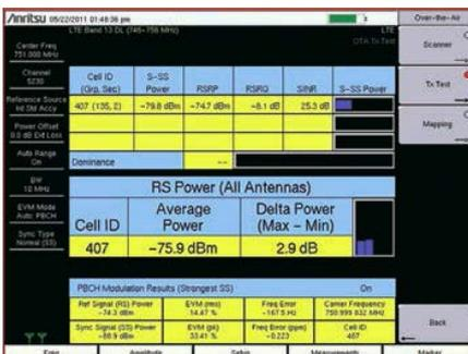
**Эфирные измерения – Тест передатчика**
