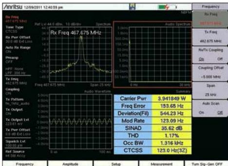
При подключении к радиосистеме функция AutoScan позволяет автоматически определить частоту неизвестного передатчика и настроиться на нее.
