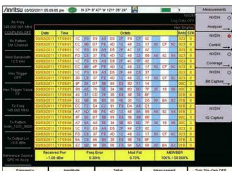
Экран канала управления NXDN содержит информацию в шестнадцатеричном формате о данных нисходящего канала транкинговой системы. Компания Anritsu предлагает бесплатный программный скрипт для конвертирования данных в шестнадцатеричном формате в текстовые сообщения.
