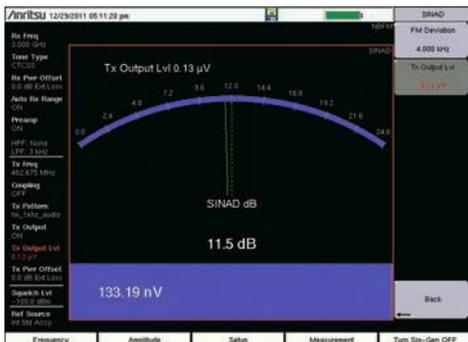
Специализированные инструменты 20 dB Quietening (подавление шумов на 20 дБ) и SINAD (отношение сигнала к шуму и искажениям) позволяют быстро и точно оценивать качество функционирования аналогового приемника.
