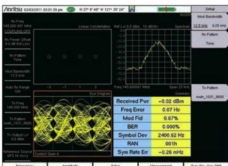
На экране анализатора сигналов NXDN отображается полная информация о качестве ВЧ сигнала.
