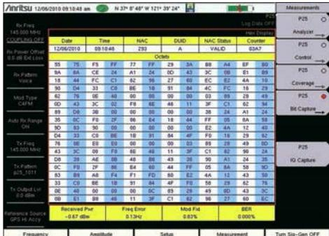
На экране DMR Bit Capture отображается трафик в восходящем канале и выполняется экспорт данных в USB-память.
