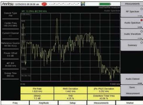
Опция 509 «Измерение параметров модуляции AM/ЧМ/ФМ» отображает спектр демодулированного аудиосигнала относительно частоты с AM (%), девиацией (кГц) или девиацией (рад) для AM/ЧМ/ФМ, соответственно.
