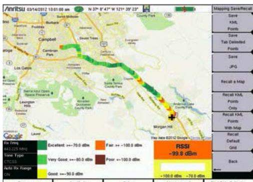
Оptionальная функция картографирования зоны покрытия позволяет отобразить результаты измерения на карте с указанием информации, полученной от приемника GPS. Точки данных отображаются с использованием цветовой кодировки на основании параметров сортировки, определенных пользователем для выбранного типа измерения.
