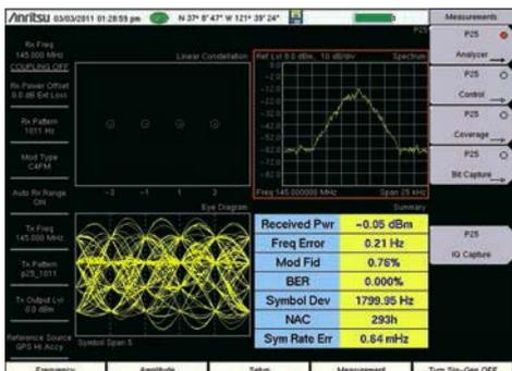
На экране анализатора сигналов DMR отображается полная информация о качестве ВЧ сигнала и модуляции.
