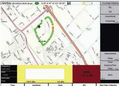
Опция 0431 «Картографирование зоны покрытия» обеспечивает выполнение измерения RSSI и ACPR одного канала с использованием пользовательской карты и привязкой данных GPS.
