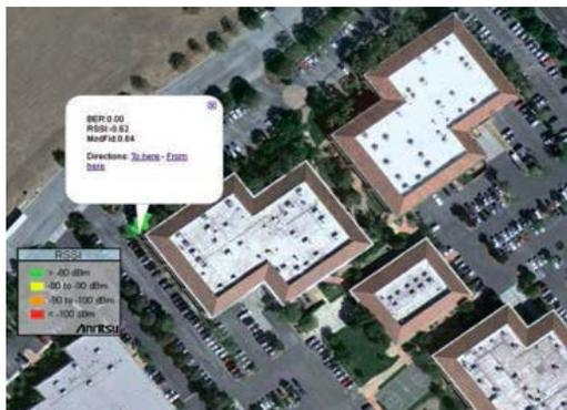
С помощью опциональной функции картографирования зоны покрытия LMR Master позволяет генерировать файл Google Earth в формате KML с указанием величин BER, Modulation Fidelity или EVM, RSSI, THD или SINAD, отображаемых с помощью цветных кнопок.
