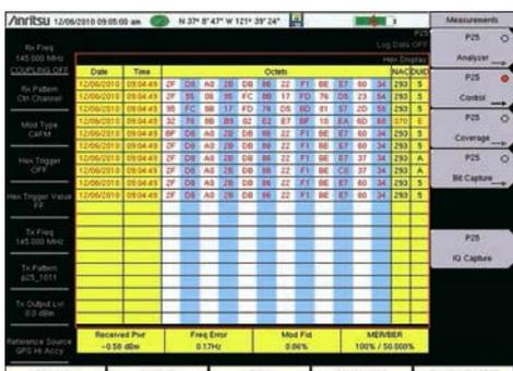
Экран канала управления DMR содержит информацию шестнадцатеричном формате о данных нисходящего канала транкинговой системы. Компания Anritsu предлагает бесплатный программный скрипт для конвертирования данных в шестнадцатеричном формате в текстовые сообщения.
