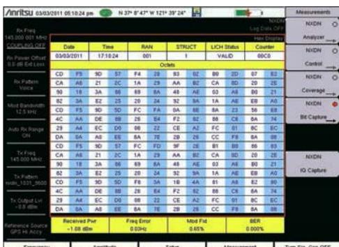
На экране NXDN Bit Capture отображается трафик в восходящем канале и выполняется экспорт данных в USB-память.
