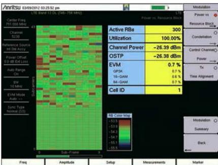
**Качество модуляции – Мощность/Ресурсный блок**
