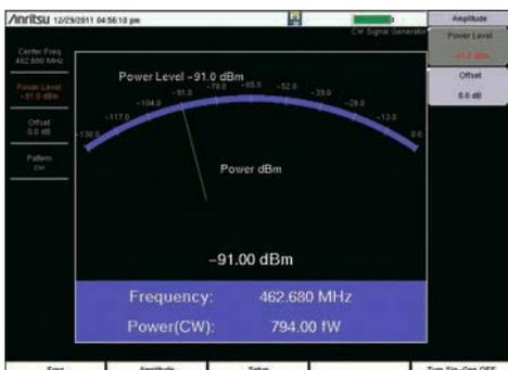
Анализатор узкополосной ЧМ может генерировать несущую с немодулированным сигналом (CW) или с ЧМ с регулируемой девиацией для схем модуляции, включая 1 кГц, CTCSS/DCS и DTMF.
