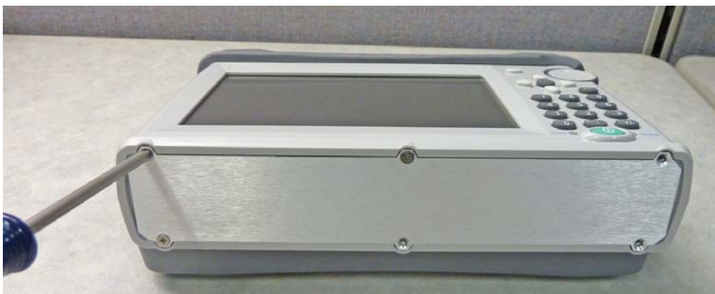
Рисунок 9-2. Снятие крышки аккумуляторного отсека
