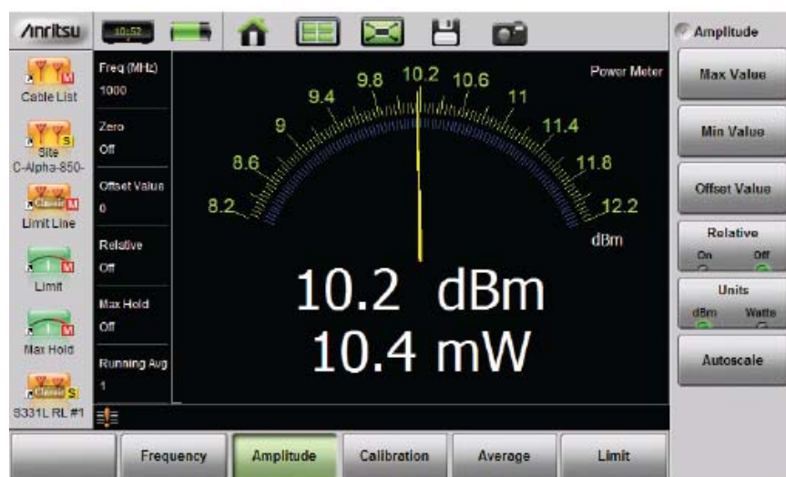
Рисунок 5-2. Применение функции Autoscale для увеличения результата измерения
