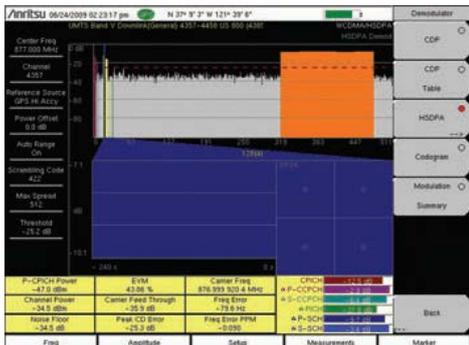
**Качество модуляции - Модуль вектора ошибки модуляции**
