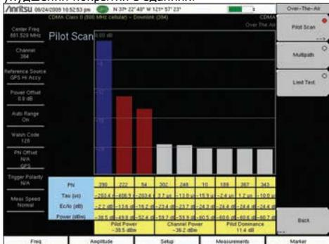
**Эфирные измерения – Мощность синхронизирующего сигнала**
