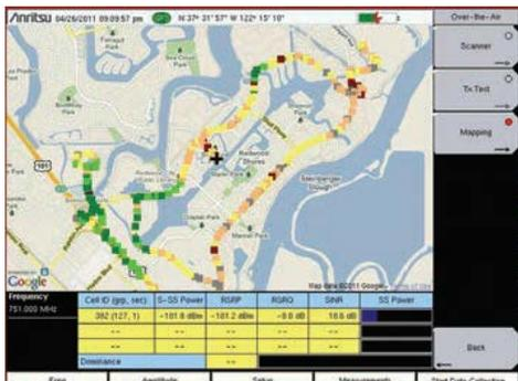
Нанесение данных на карту в эфирном режиме MapMaster™ позволяет импортировать карту в прибор для проверки покрытия по нисходящему каналу мощности S-SS, RSRP, RSRQ или SINR.
