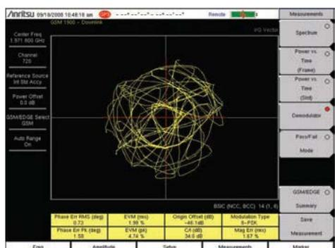
**Демодуляция – Модуль вектора ошибки модуляции (EVM)**
