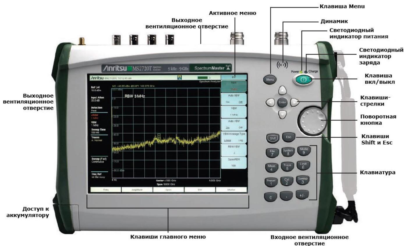
**Компактные размеры: 315 мм × 211 мм × 77 мм**
