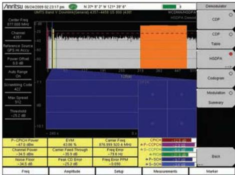
**Демодуляция – Модуль вектора ошибки модуляции (EVM)**
