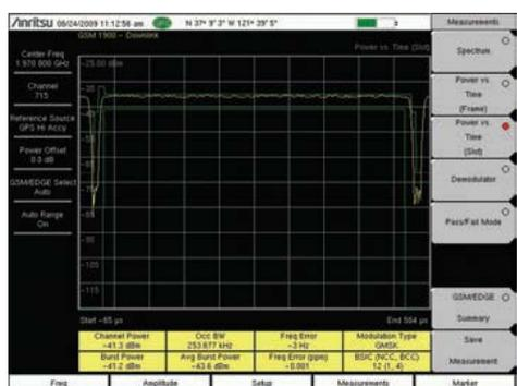
**ВЧ измерение – средняя мощность импульса**
