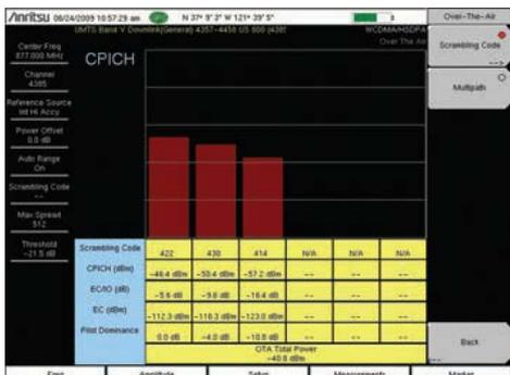
**Эфирные измерения – Мощность синхронизирующего сигнала**
