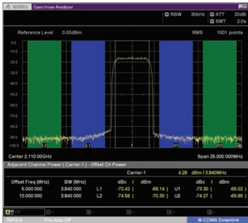
W-CDMA ACLR, 1 Carrier (TestModel1, 64DPCH)
