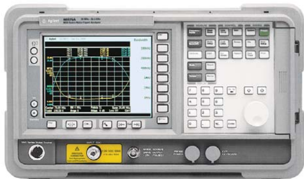
Встроенный цветной дисплей с диагональю 17 см обеспечивает одно- или полиэкранное отображение результатов одновременного измерения коэффициента усиления и коэффициента шума.
