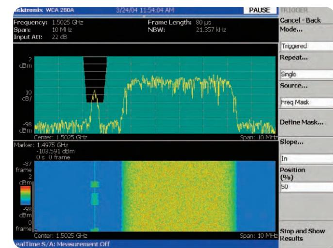
**Рис. 1-8.** Использование частотной маски для синхронизации по импульсу низкого уровня в присутствии большого сигнала
