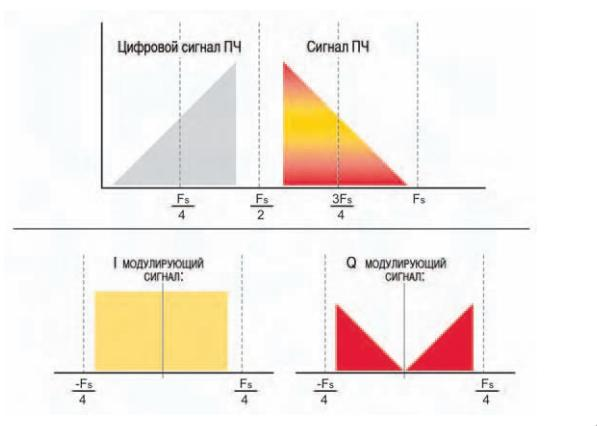
**Рис. 2-3.** Данные, относящиеся к полосе частот, хранятся в потоках *I* и *Q*, даже при вдвое меньшей частоте дискретизации
