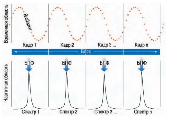
**Рис. 1-5.** Выборки, кадры и блоки: иерархия памяти анализатора спектра в реальном масштабе времени
