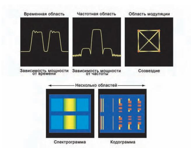
Рис. 1-12. Примеры нескольких синхронных измерений, с помощью анализатора спектра в реальном масштабе времени
