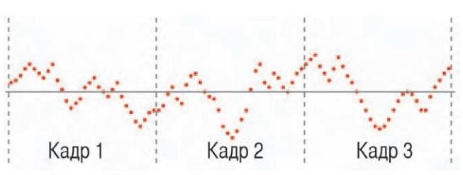
Рис. 2-12. Три кадра дискретизированного сигнала во временной области
