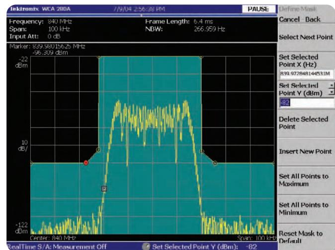
**Рис. 2-9.** Определение частотной маски
