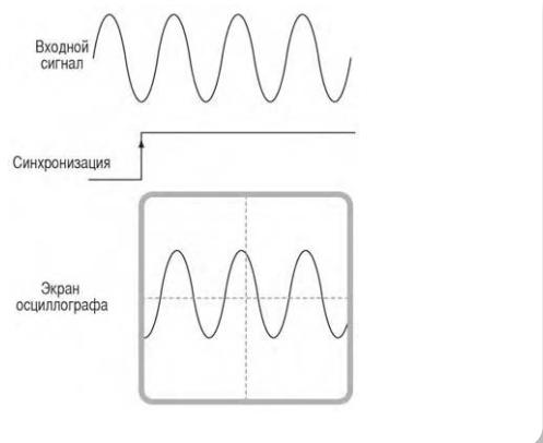
Рис. 2-6. Синхронизация в обычном осциллографе
