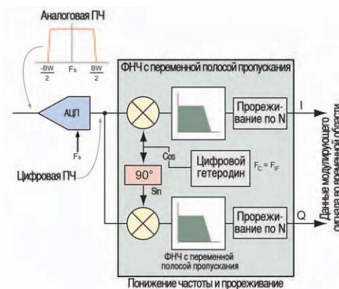
**Рис. 2-2.** Блок-схема цифрового преобразователя с понижением частоты
