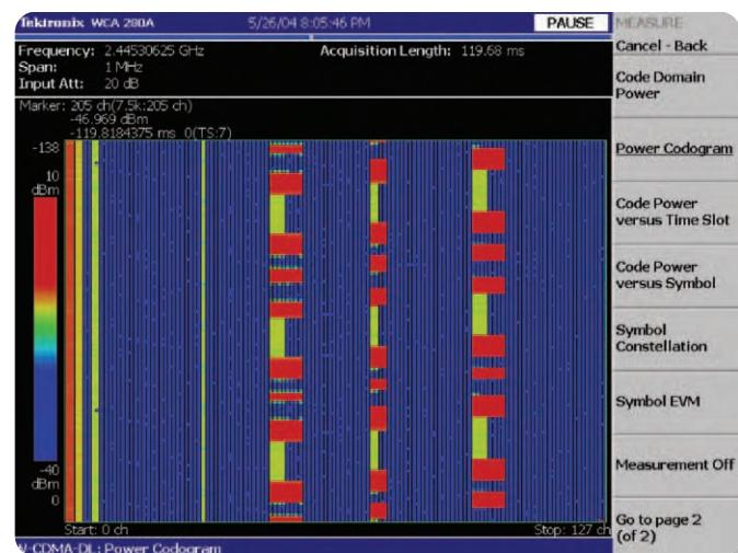
**Рис. 3-20.** Измерение кодограммы для режима сжатия W-CDMA
