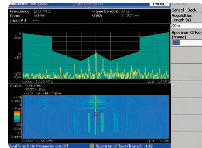
**Рис. 1-9.** Использование частотной маски для синхронизации по особому сигналу в сложных спектральных условиях
