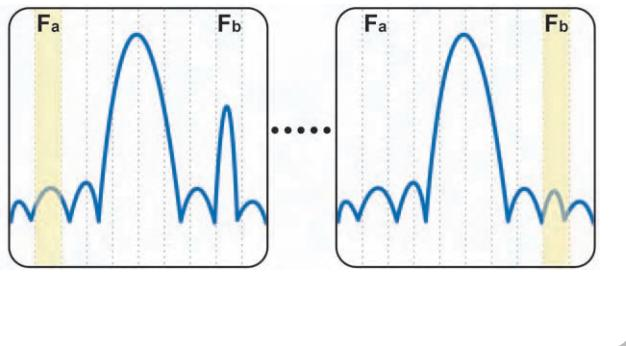
**Рис. 1-1.** Аналитор спектра с разверткой последовательно просматривает частоты. При этом часто оказываются пропущенными важные нестационарные события, происходящие вне текущей полосы частот развертки (на рисунке отмечена желтым)
