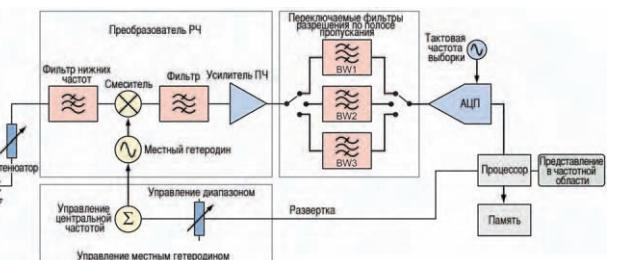
**Рис. 1-2.** Типичная схема анализатора спектра с разверткой
