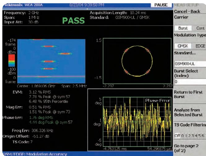
**Рис. 3-18.** Спектrogramма, диаграмма «созвездие», оценка модуля ошибки, зависимость ошибки фазы от времени для сигнала GSM с переключением частоты
