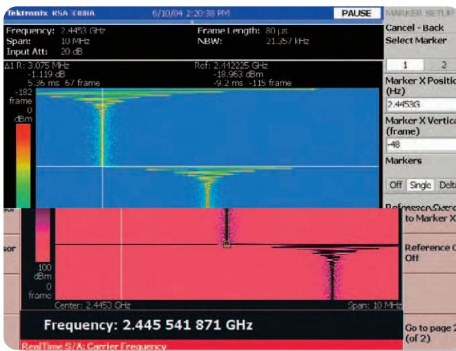
**Рис. 3-1.** Просмотр спектограммы сигнала со скачкообразным изменением частоты в режиме анализа в реальном масштабе времени
