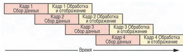
**Рис. 2-15.** Захват, обработка и отображение сигнала с использованием перекрывающихся кадров
