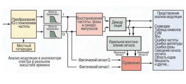
**Рис. 2-18.** Блок-схема анализа модуляции с помощью анализатора спектра в реальном масштабе времени
