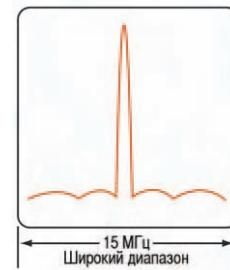
**Рис. 2-4.** Пример захвата с широкой полосой частот
