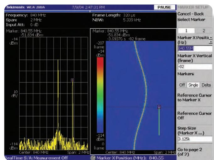
Рис. 1-11 Синхронные представления: зависимость мощности от частоты (слева) и спектrogramma (справа)
