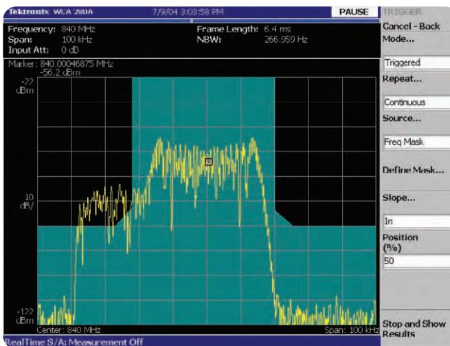
**Рис. 2-11.** Один кадр спектограммы, на котором показано событие синхронизации, когда нестационарный сигнал нарушает границу частотной маски
