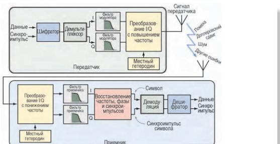
Рис. 2-17. Типичная система цифровой связи
