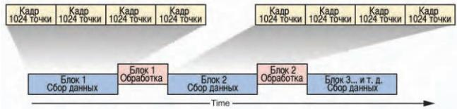
**Рис. 1-6.** Регистрация и обработка блоков данных с помощью анализатора спектра в реальном масштабе времени
