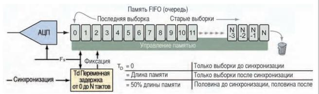
Рис. 2-7. Синхронизация в системах цифровой регистрации сигналов
