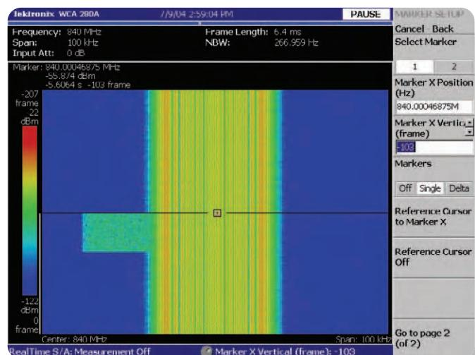
**Рис. 2-10.** Спектрограмма, на которой представлен нестационарный сигнал рядом с несущей. Курсор помещен в точку синхронизации, поэтому данные, соответствующие времени до начала синхронизации отображаются выше линии курсора, а данные, соответствующие времени после начала синхронизации — ниже линии курсора. Узкая белая линия слева от области голубого цвета обозначает данные, относящиеся к периоду после синхронизации
