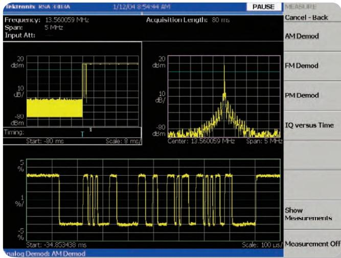
**Рис. 3-11.** Анализ демодуляции импульсного AM-сигнала с использованием модуляции с амплитудной манипуляцией для кодирования данных
