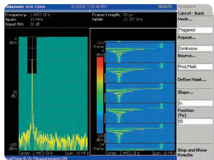
**Рис. 3-2.** Режим анализа спектра в реальном масштабе времени: несколько блоков, зарегистрированных с использованием синхронизации по частотной маске для измерения повторяемости нестационарных сигналов с переключением частоты
