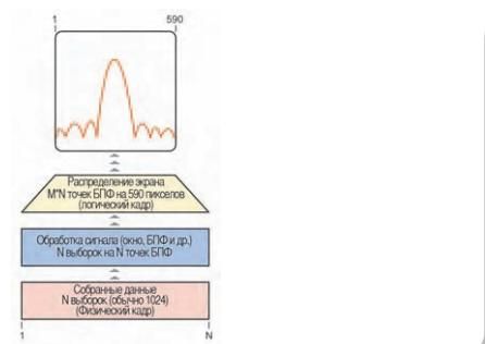
**Рис. 4-3.** Стандартный режим анализа спектра: сопоставление данных для диапазонов, не превышающих ширину полосы пропускания в реальном масштабе времени
