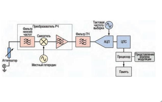
Рис. 1-3. Схема типичного векторного анализатора сигналов
