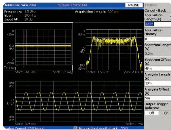
**Рис. 3-12.** Анализ демодуляции ЧМ-сигнала, модулируемого синусоидальным сигналом
