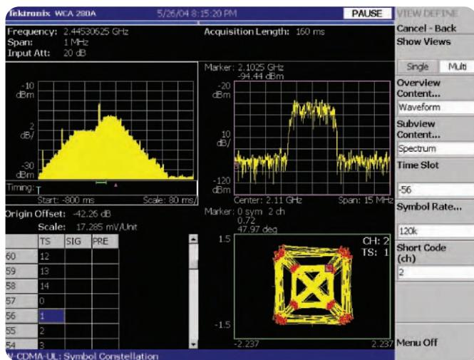
**Рис. 3-17.** Анализ модуляции гарнитуры W-CDMA в условиях управления мощностью с петлей обратной связи. Диаграмма «созвездие» (внизу справа), на которой представлена ошибка, связанная с большими выбросами, происходящими во время переходов между уровнями, которые можно увидеть на графике зависимости мощности от времени (вверху слева)
