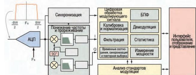
**Рис. 2-1.** Блок-схема цифрового преобразования сигналов в анализаторе спектра в реальном масштабе времени
