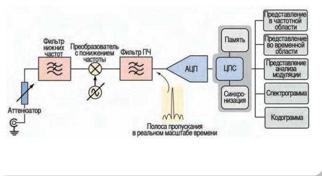
Рис. 1-4. Схема типичного анализатора спектра в реальном масштабе времени
