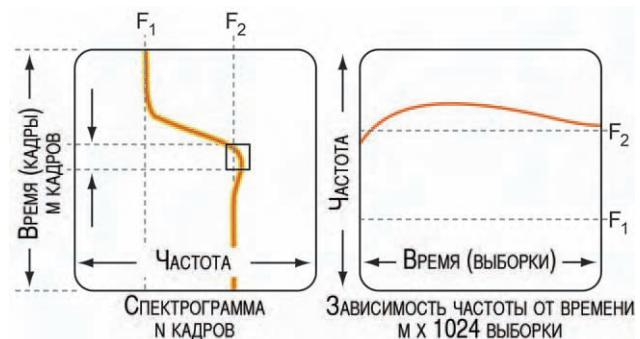
**Рис. 3-4.** Сравнение отображения спектрограммы и зависимости частоты от времени
