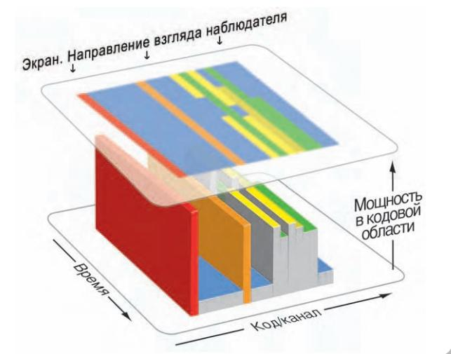
**Рис. 3-19.** Пример отображения кодограммы
