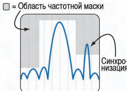
**Рис. 1-7.** Синхронизация в частотной области в реальном масштабе времени с использованием частотной маски
