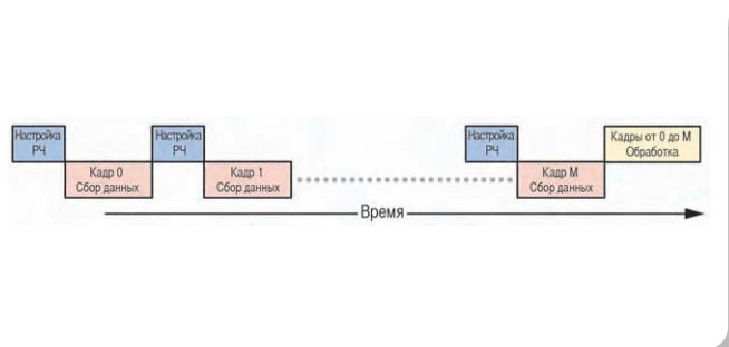
**Рис. 4-1.** Регистрация и обработка сигнала в стандартном режиме анализа спектра
