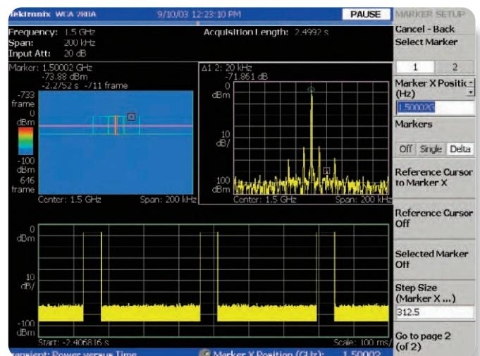
Рис. 1-14. Просмотр нескольких областей: спектrogramма, зависимость мощности от частоты и мощности от времени
