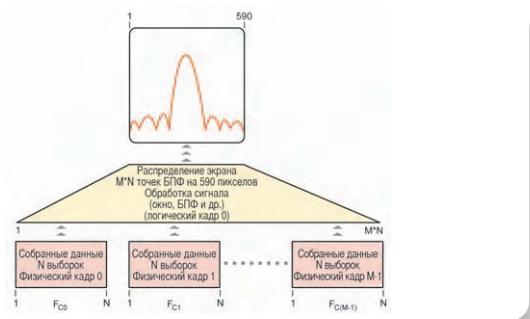
**Рис. 4-2.** Стандартный режим анализа спектра: сопоставление данных для диапазонов, превышающих ширину полосы пропускания в реальном масштабе времени.  $N$  выборок для каждого физического кадра,  $M$  физических кадров и 1 логический кадр
