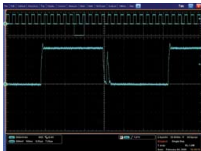
Рис. 47. Чем выше частота выборки, тем выше разрешение отображаемого на экране сигнала, что гарантирует возможность просмотра быстрых переходных процессов.
