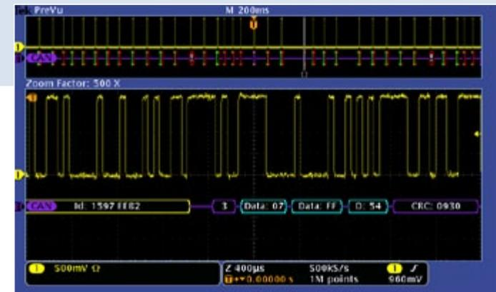
Осциллографы с длиной записи в миллионы точек могут выполнять захват в течение длительного времени, что очень важно для исследования сложных сигналов. Расстановка **маркеров** помогает, например, измерять задержки на шине CAN.
