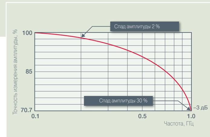
Полоса пропускания определяется как полоса частот, в пределах которой входной синусоидальный сигнал ослабляется осциллографом не более чем до 70,7 % или по уровню -3 дБ (по уровню половинной мощности), как показано на данном рисунке для осциллографа с полосой пропускания 1 ГГц.
