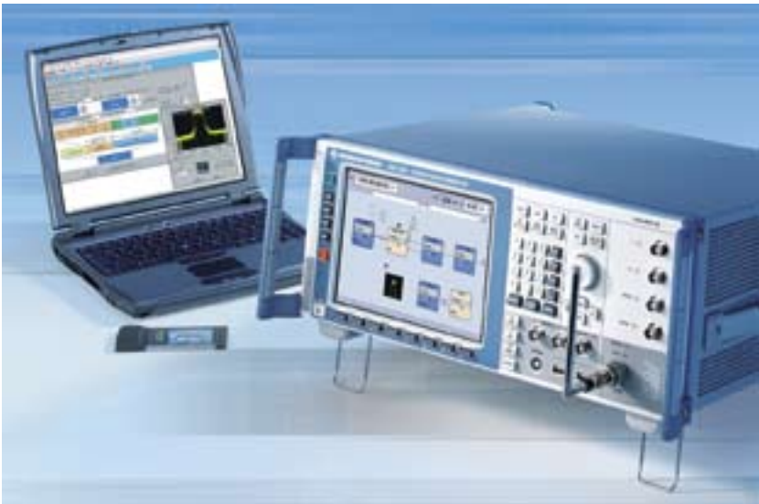
R&S®SMJ100A с компьютером и картой WLAN
