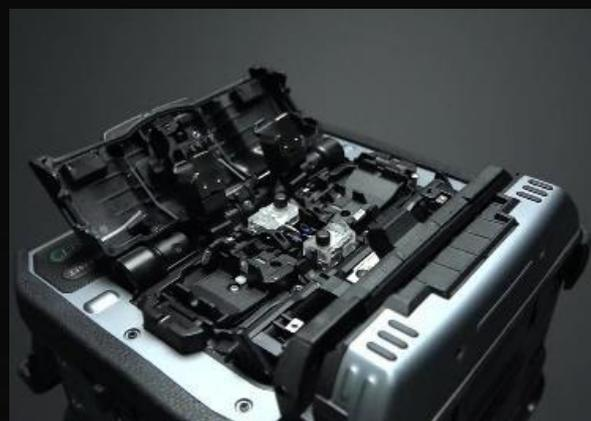
Фиксаторы помогают при автоматизации процессов. При автоматическом открытии зажимов после сварки, фиксаторы волокна аккуратно удерживают его от выскакивания. Фиксаторы открываются, когда волокно поднимается вручную.
