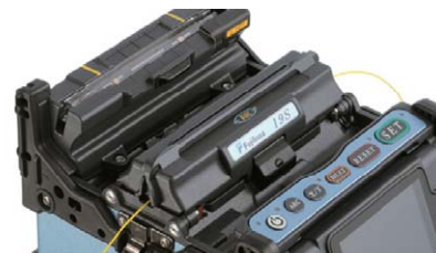
После сварки крышка открывается
