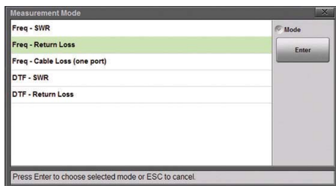
Экран выбора типа измерения в «Классическом режиме». Вид, знакомый по моделям серии D.
