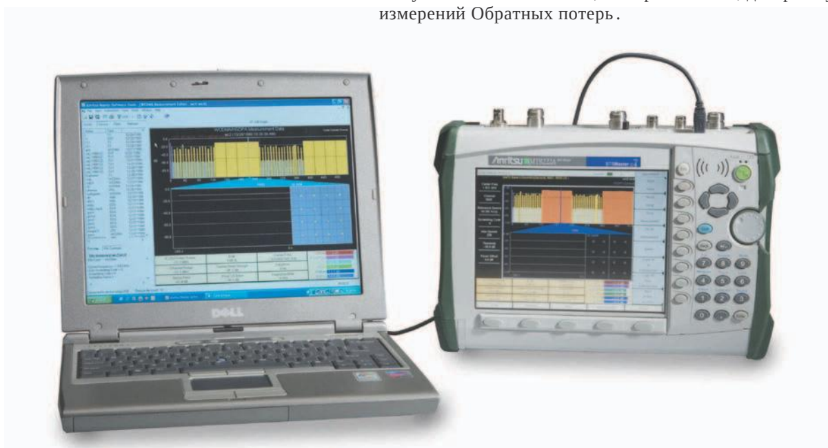
Master Software Tools вместе с Mappoint с помощью информации GPS, отображает географические координаты объектов где производились измерения.
