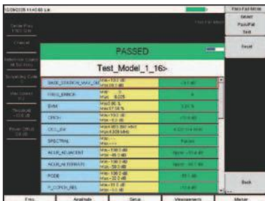
MT8222A - проводит проверку по системе Прошел/Не прошел для быстрой оценки состояния базовой станции.
