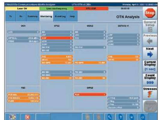
Экран ошибок и аварийных сигналов OTN, показывающий каждый сетевой уровень
