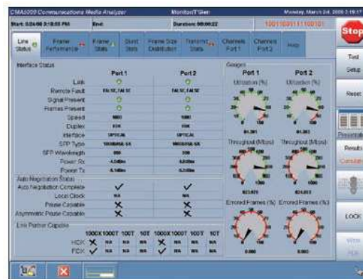
Результаты измерения для двух портов с установкой порогов, регулируемых пользователем
