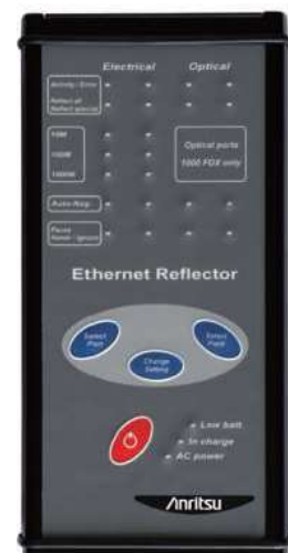
Внешний вид CMA Ethernet Reflector
